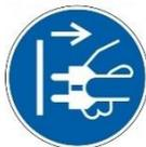
*Trennen Sie bei der Montage oder Wartung des Filters das Gerät von der Stromversorgung.*
